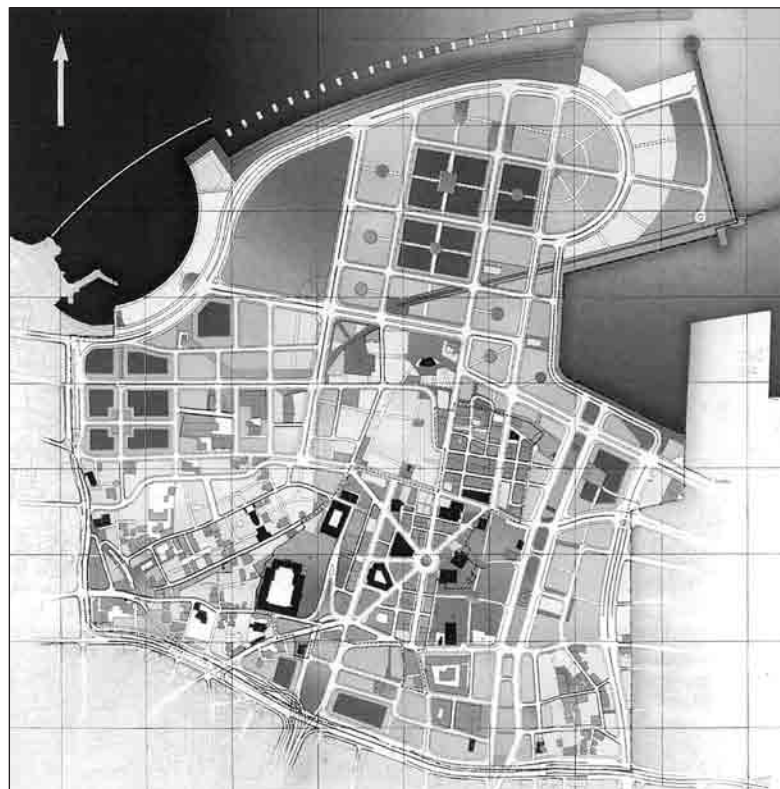
Plan de reconstruction du centre-ville remanié en 1993. On remarque l'extension des remblais avec la création d'un parc public et de deux marinas.
